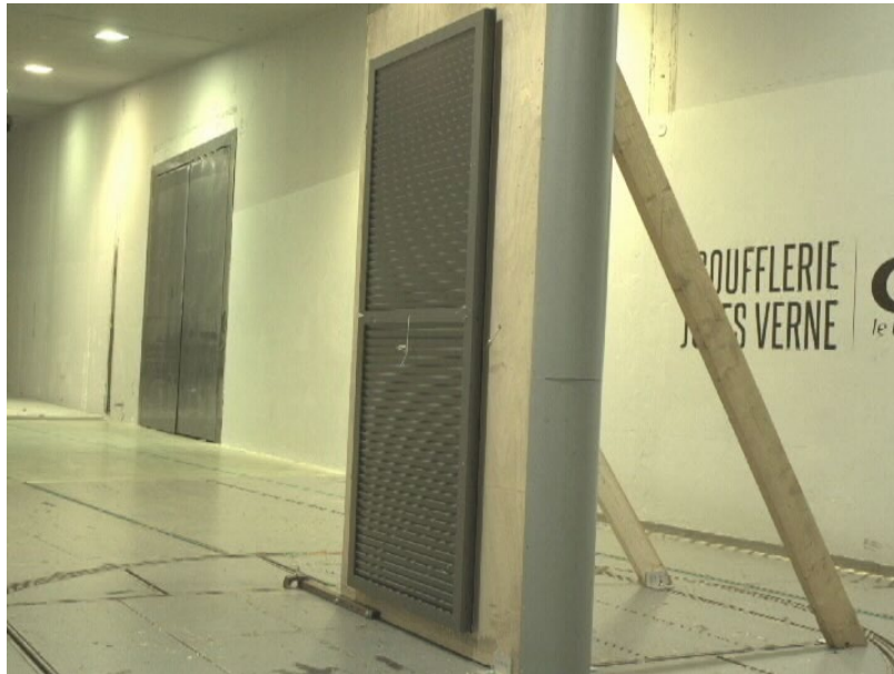
Figure 3 : volet 4 vantaux en aluminium dans la configuration partiellement fermée
