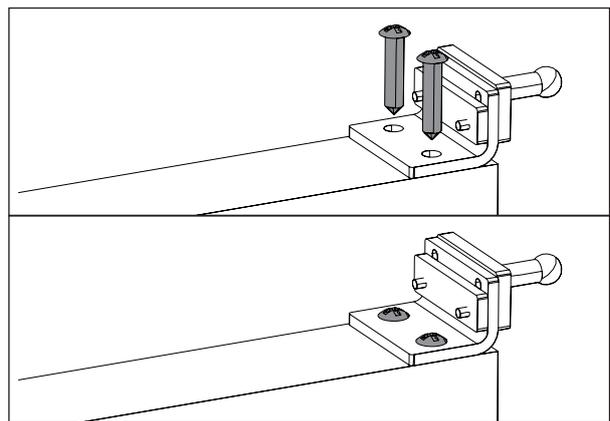
4. Fixer l'équerre au bout du vantail, côté ouverture (vis non fournies).
