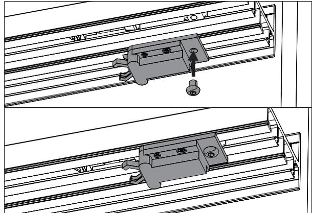
2. Placer le loqueteau avec sa plaque support sous le rail. Positionner le pli de la plaque support coté fermeture du vantail pour que la course de la vis ne sorte pas du rail. Fixer avec la vis au système ressort. Ne pas serrer complètement.
