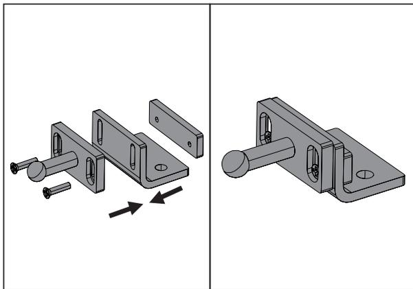
3. Assembler l'équerre et le support du loqueteau avec la plaque sans serrer les vis.
