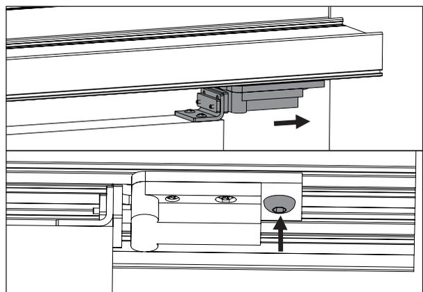
6. Faire coulisser le vantail avec le support équerre pour le clipser au loqueteau. Amener l'ensemble au bord du rail. A la position souhaitée, serrer la vis pour que l'ensemble soit maintenu.
