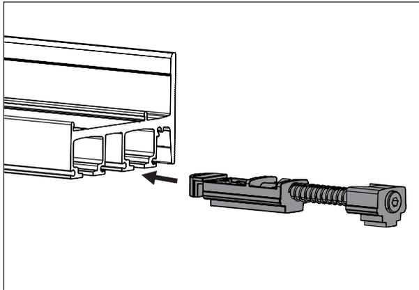
1. Insérer le système ressort dans le rail, la tête de la vis vers l'extrémité du rail, côté ouverture.
