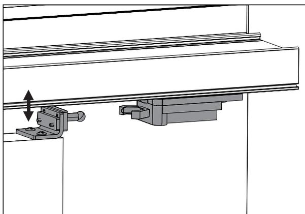
5. Positionner le vantail dans le rail et ajuster la hauteur de l'équerre en fonction de la position du loqueteau fixé au rail. Serrer les vis.
