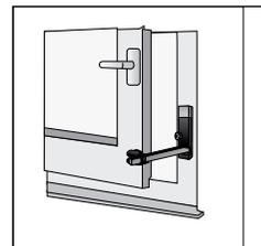
**4.** Repérer les perçages à effectuer pour la partie verrou (a) en déverrouillant le pêne pour rendre visible les trous de logement des vis. Pour le support crémaillère (b), repérer les perçages à effectuer à l'oblique afin de priver l'accès aux vis en position horizontale (verrouillée) ou verticale (déverrouillée).
