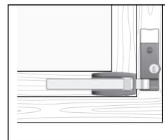
**2.** Ajuster si besoin le positionnement du DASISTAS®2 à l'aide des cales de compensations fournies. La crémaillère doit être parallèle à la fenêtre en position fermée. Respecter un espace fonctionnel minimum de 2 mm entre le verrou et le support crémaillère.
