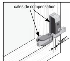
**3.** Contrôler le fonctionnement. Ouvrir la menuiserie jusqu'à la limite maximum autorisée par l'entrebâilleur DASISTAS®2 en maintenant les pièces en position, puis la refermer. La crémaillère ne doit en aucun cas entrer en contact avec l'ouvrant.
