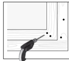
**6.** Fixer le verrou et le support crémaillère sur la menuiserie. S'assurer de la bonne compatibilité des vis utilisées avec le matériau support (menuiserie PVC, aluminium, bois, etc..)
