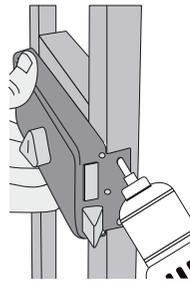
2. Percer les avant-trous (Ø5) des vis de fixation de la tête.
