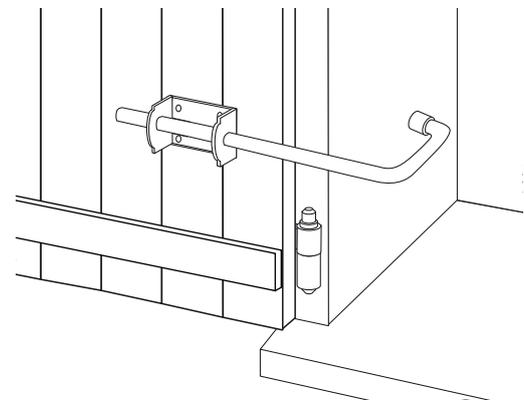
2. Volet ouvert complètement (en appui sur le mur) : Passer la tige dans la platine, butée caoutchouc coté fenêtre. La poignée en appui sur le tableau de la fenêtre, faire un repère sur la tige ronde **A**.
