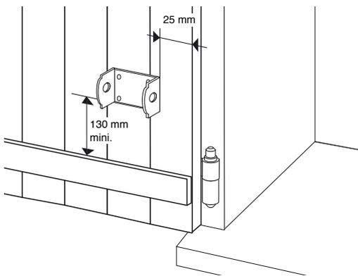
1. Fixer la platine horizontalement à 25 mm du bord du volet et au minimum 130 mm du bas du volet ou de la barre de renfort. Trous de diamètre 6 mm.
