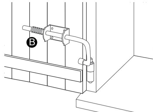
4. Remettre la poignée en place et glisser le ressort et la bague à oreilles sur la tige ronde Positionner la bague sur **B** et serrer les 2 oreilles.
