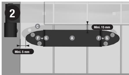
Sur le volet, positionner le support poignée (A), tracer, percer et assembler avec la contre-plaque (C) et les vis (F) et les écrous (G) x4.
