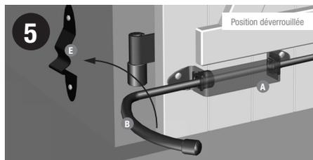
Lors du verrouillage, le volet doit être plaqué sur la façade et la poignée (B) doit forcer sur la butée de tableau (E) pour venir prendre sa position et verrouiller le volet en position ouverture. Plaquer la bride (D) contre le support poignée (A) et serrer la vis sur la bride.
