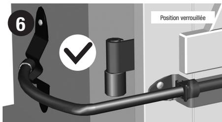
L'effort pour permettre la fermeture du volet doit être réalisé sans à-coup sous risque de dérèglement du système.
