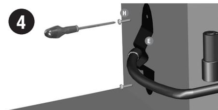
Positionner la butée de tableau (E), tracer, percer, cheviller, et fixer avec les vis (H) x2.
