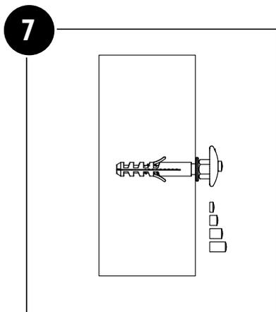
Ajuster le tampon sur la gâche-butée, en fonction de l'épaisseur du volet.
