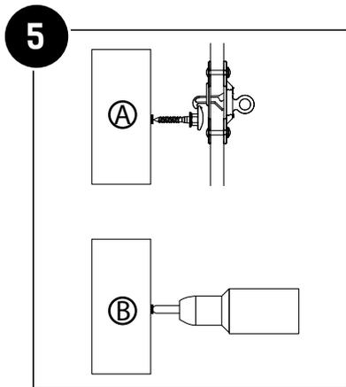
A) Tracer la position de la gâche-butée sur le mur, en fonction de la position de l'arrêt. B) Percer Ø 14.
