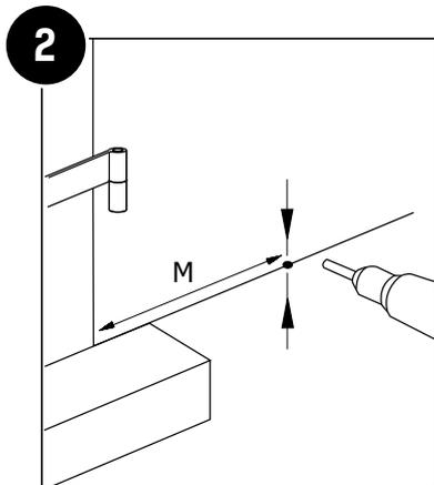
Déterminer la position de l'arrêt composite à ressort.
