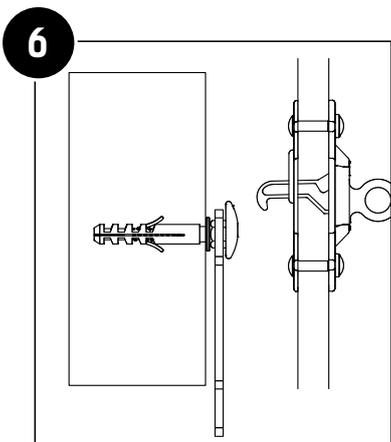
Mettre en place et régler la gâche-butée pour assurer un bon fonctionnement de l'ensemble.
