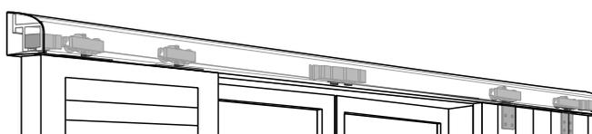
Motorisation par courroie (Moteur en bout de rail)
