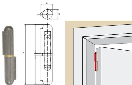
**SBR.. SOUDAROC® Paumelle à souder bouts ronds Bague Laiton**
