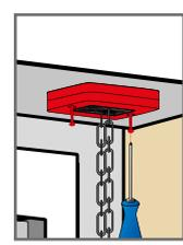
5. Centrer sur l'ouverture et fixer le guide-chaîne avec les 2 vis.
