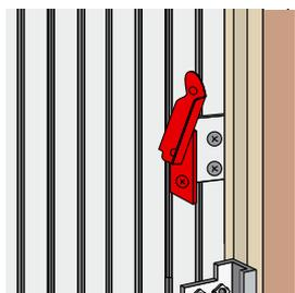
**B0244..** Arrêt sur équerre mortaisée avec butée
