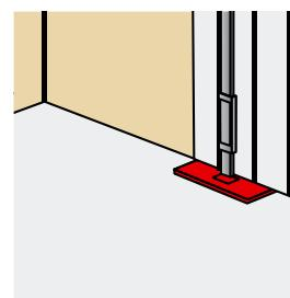
**Demi-sabot verrou composite monté sur platine**
