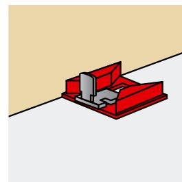
**Sabot de guidage composite monté sur platine**
