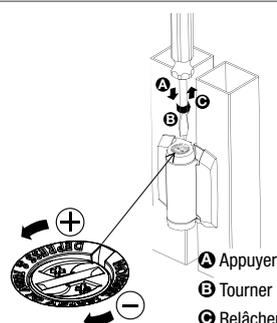
Augmentez ou diminuez la tension du ressort (vitesse de fermeture) en quelques secondes !
