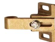
Ce régulateur s'adapte sur tous types de portails PVC, bois ou acier. Il permet de remonter une pente jusqu'à 10% de la largeur du vantail, avec un entraxe d'un mètre entre les gonds inférieurs et supérieurs et de rester dans un plan perpendiculaire au sol.
