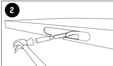
A l'aide d'une mortaiseuse ou d'un ciseau à bois et d'un marteau, mortaisez.
