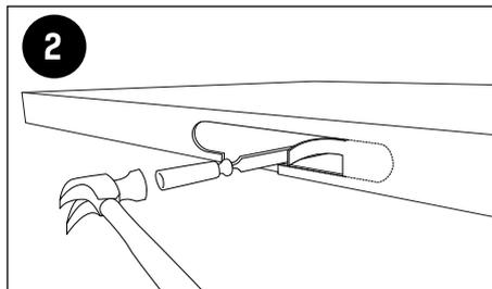
À l'aide d'une mortaiseuse ou d'un ciseau à bois et d'un marteau, mortaisez.
